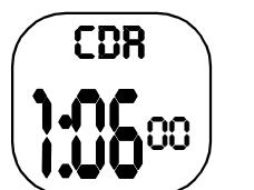
Oprima repetidamente el botón **ADV/ST/SPL.** para cambiar el parámetro seleccionado; despues oprima repetidamente el botón **MODE** para seleccionar los segundos, los minutos y la hora, así como el modo de cuenta regresiva.
